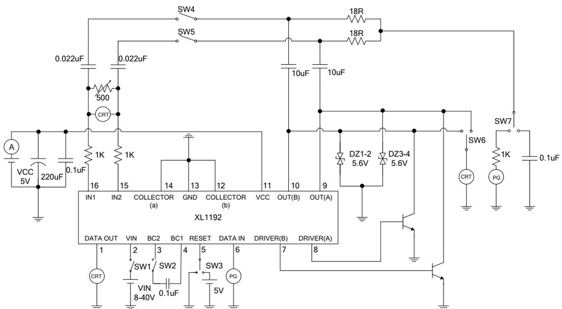
图 7. XL1192 测试电路图 (外置晶体管)
