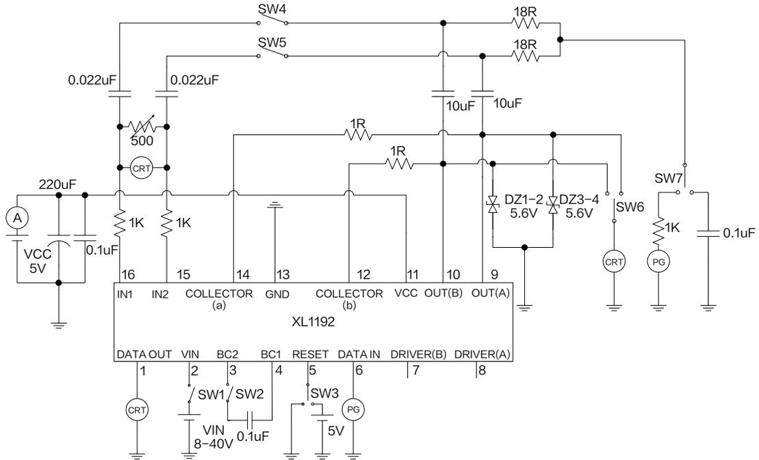
图 6. XL1192 测试电路图 (无外置晶体管)
