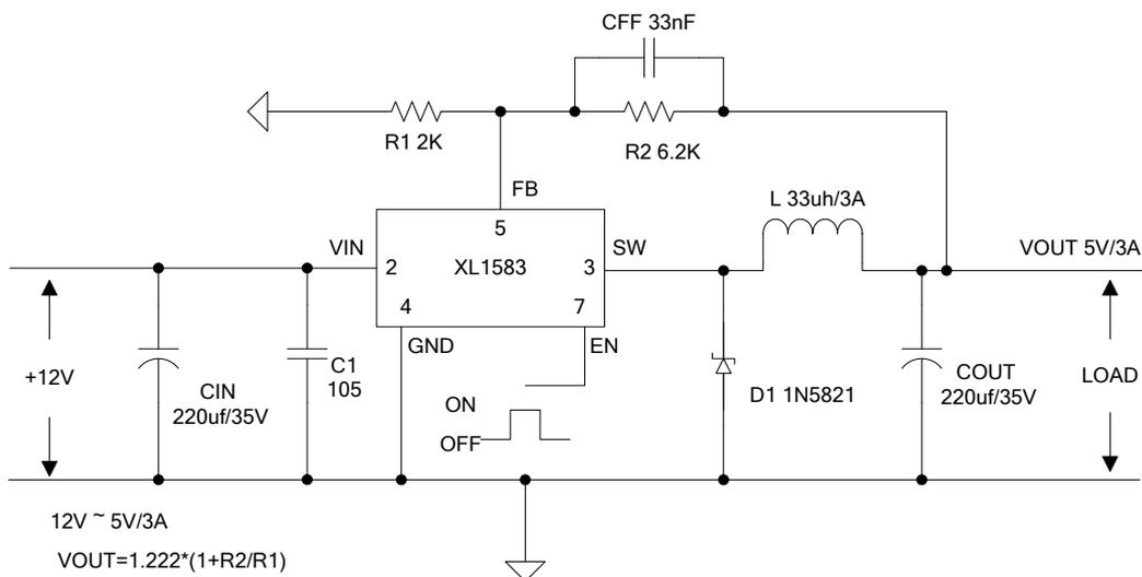
图 6. XL1583 系统参数测量电路(12V ~ 5V/3A)
