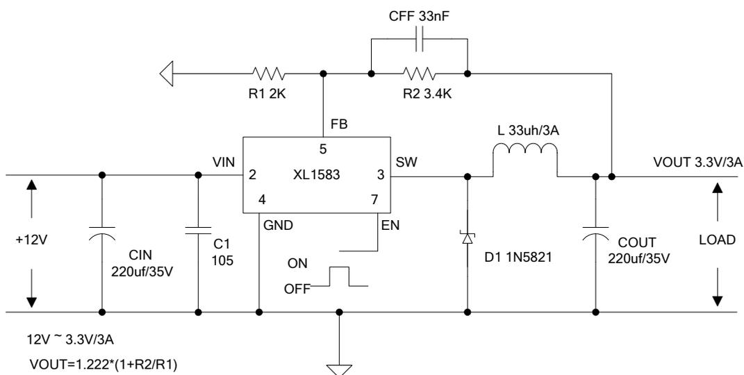
图 7. XL1583 系统参数测量电路(12V ~ 3.3V/3A)
