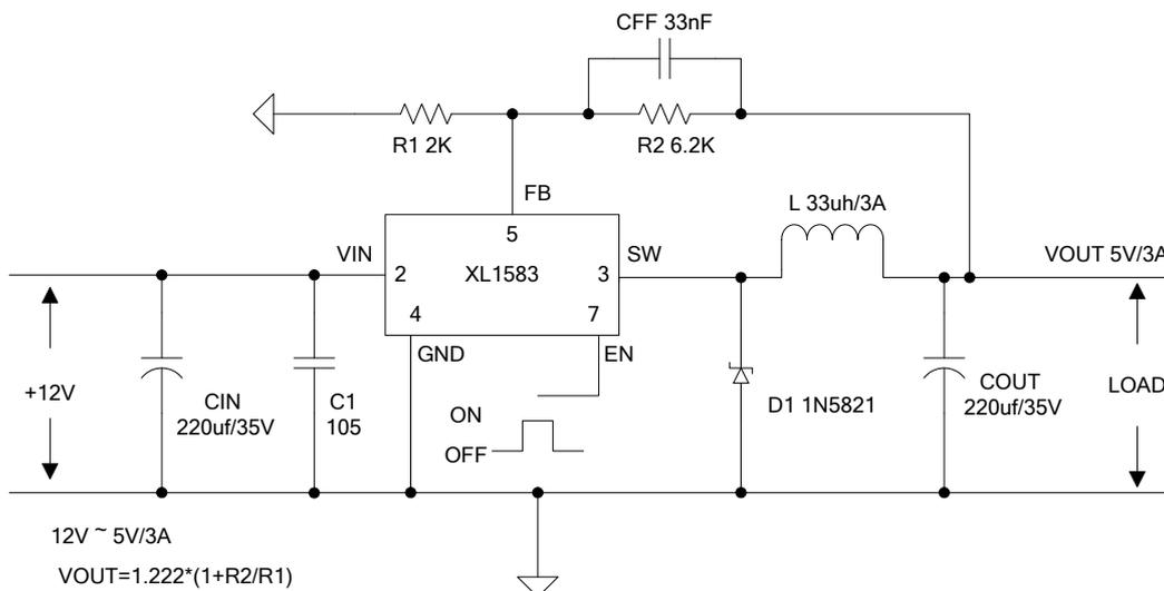
图 4. XL1583 系统参数测量电路(12V-5V/3A)
