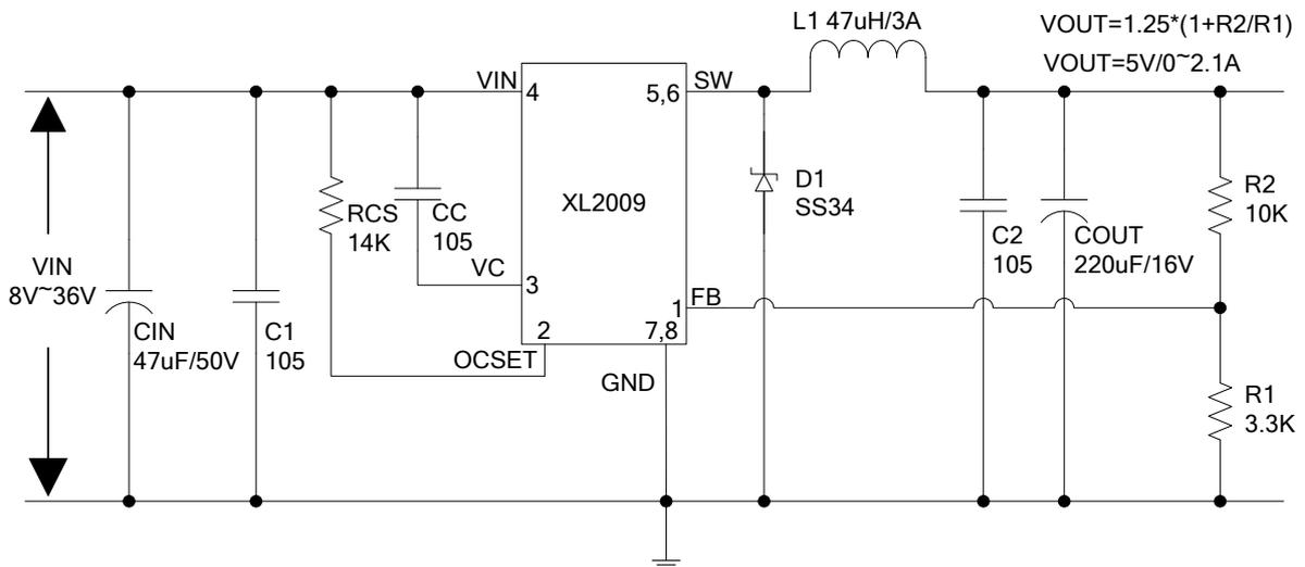
图 5.XL2009 系统参数测量电路 (VIN=8V~36V,VOUT=5V/2.1A)
