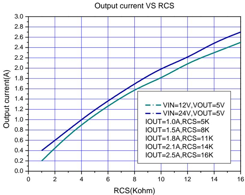
图 8.输出电流曲线
