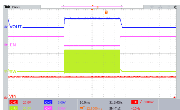
图 39.EN 引脚开关机波形 ( V_{IN}=48V , V_{OUT}=5.0V , I_{OUT}=0.5A )
