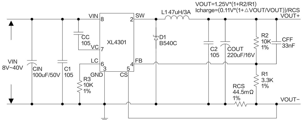
图 10. XL4301 系统参数测量电路 (VIN=8V~40V, VOUT=5V/0.1A~2.5A)
