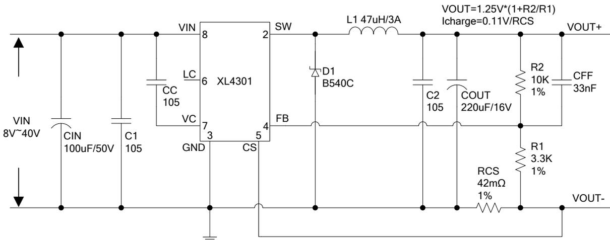
图 5.XL4301 系统参数测量电路 (VIN=8V~40V,VOUT=5V/0.1A~2.5A)
