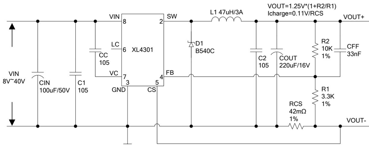
图 4. XL4301 系统参数测量电路
