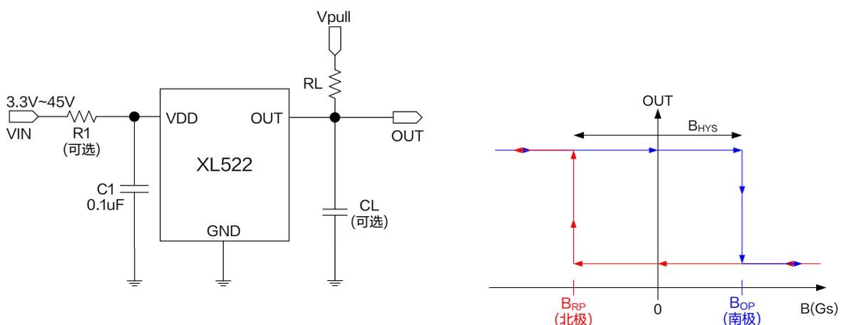
图 1. XL522 典型应用示意图和输出特性曲线
