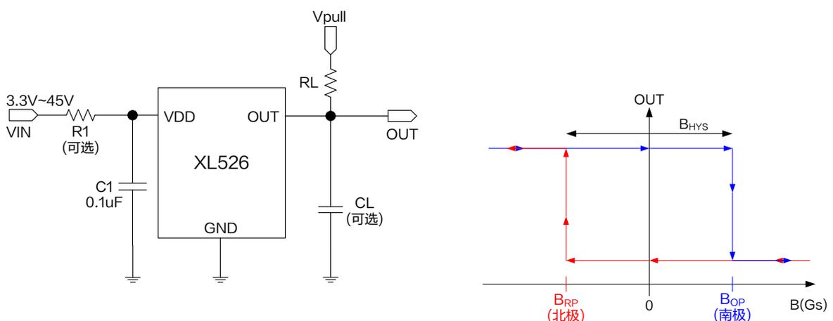
图 1. XL526 典型应用示意图和输出特性曲线
