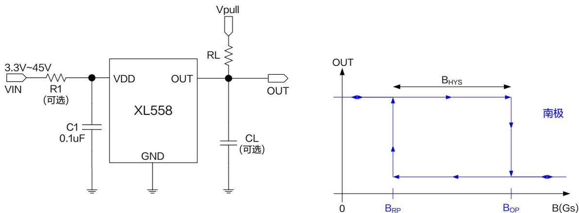
图 1. XL558 典型应用示意图和输出特性曲线
