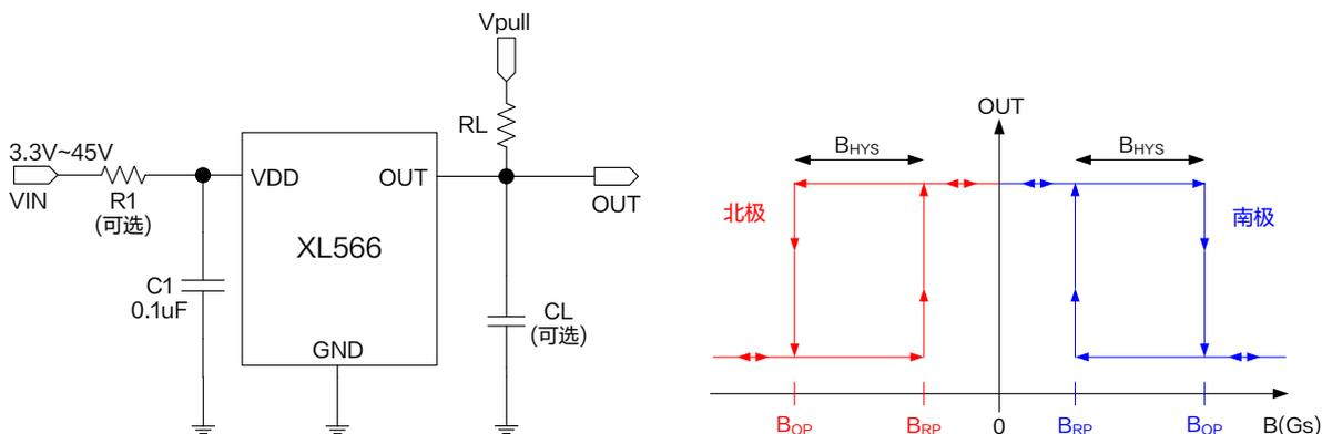
图 1. XL566 典型应用示意图和输出特性曲线
