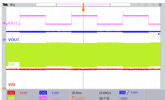
图 28.瞬态负载响应波形 ( V_{IN}=24V , V_{OUT}=5.0V , I_{OUT}=0 至 1A )
