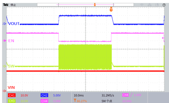
图 36.EN 引脚开关机波形 ( V_{IN}=24V , V_{OUT}=5.0V , I_{OUT}=0.5A )
