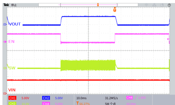
图 34.EN 引脚开关机波形 ( V_{IN}=8V , V_{OUT}=5.0V , I_{OUT}=0.5A )
