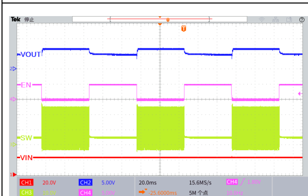
图 33.EN 引脚开关机波形
