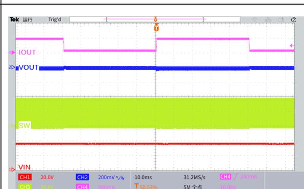
图 25.瞬态负载响应波形
