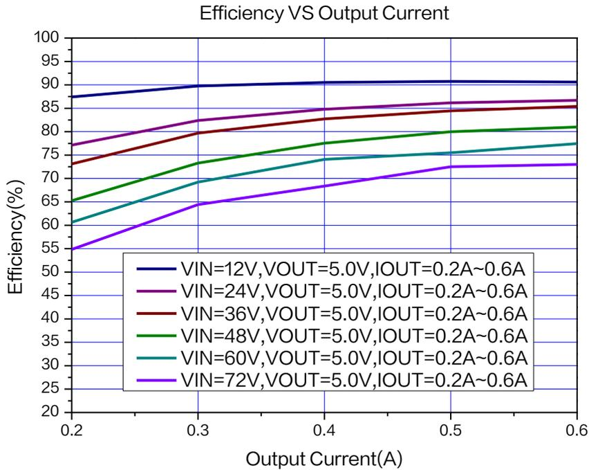
图 7. XL9711 系统效率曲线 ( $V_{OUT}=5.0V$ )
