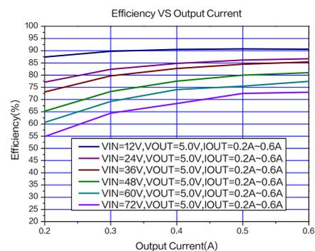
图1.XL9711典型应用示意图和转换效率曲线
