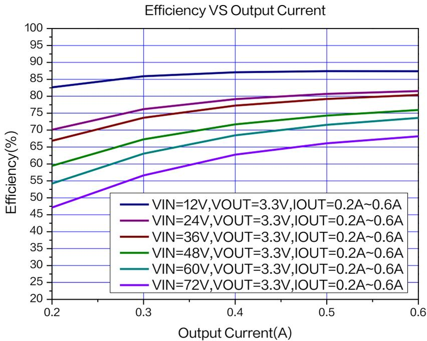
图 5. XL9711 系统效率曲线 ( $V_{OUT}=3.3V$ )
