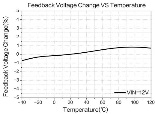
图 10. 反馈电压温度系数曲线图
