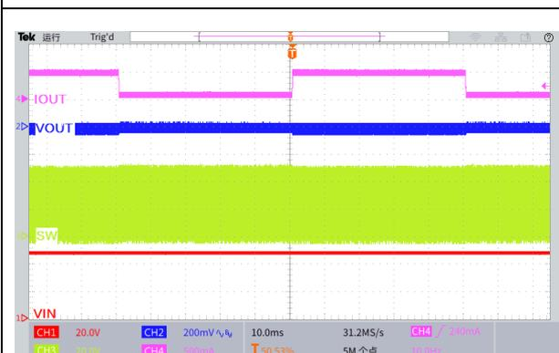
图 26.瞬态负载响应波形
