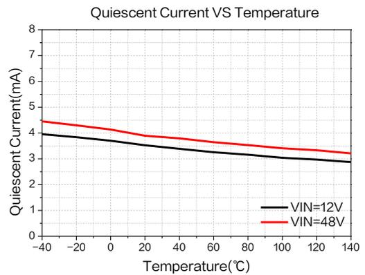
图 11. 静态电流温度系数曲线图
