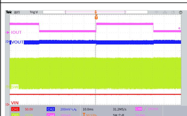
图 27.瞬态负载响应波形
